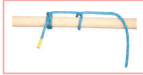
Kazık ve Ala Bağ Uygulaması
