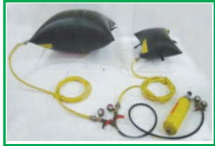
Kaldırma Yastıklarının Görünümleri
