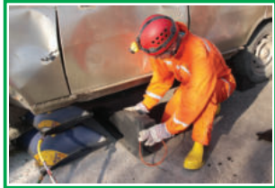
Kaldırma Yastıklarının Desteklenmesi
