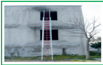
Sürgülü Merdiven ve Açılmış Görünümü
