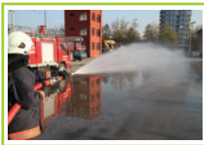
Musluklu Lans ile Direk ve Pülverize Su işleme
