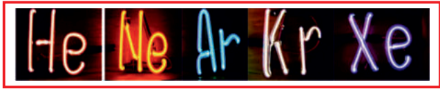
Neon tüplerinde kullanılan farklı soygazların ürettiği renkler
