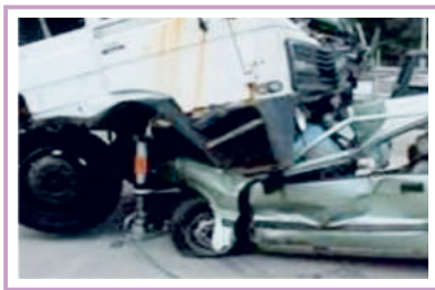
Sıkışan Bir Aracın Araç Altından Çekilmesi İçin Büyük Aracın Hidrolik Silindire Yükseltilmesi
