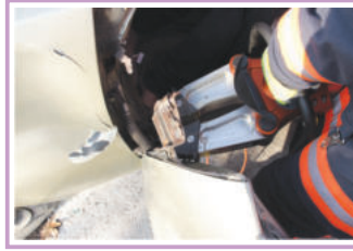
Kapının Kilit Tarafından Ayrıcı ve Kesiciler Kullanarak Açılması Ayrıcı ile Mentешelerin Koparılması Çalışmaları
