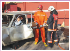
Kapının Kilit Tarafından Ayırıcı ve Kesciler Kullanılarak Açılması Ayırıcı ile Menteşelerin Koparılması Çalışmaları
