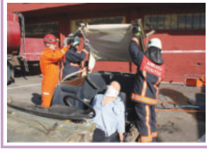
Kapı Açma ve Tavanı Gövdeye Bağlayan Tüm Direklerin Kesilmesinden Sonra Tavan Komple Çıkarılabilir.
