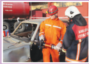
Kapı Açma ve Tavanı Gövdeye Bağlayan Tüm Direklerin Kesilmesinden Sonra Tavan Komple Çıkarılabilir.
