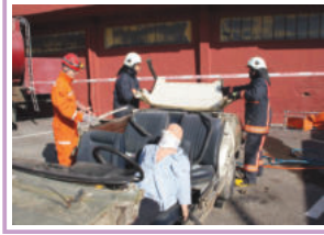
Kapı Açma ve Tavanı Gövdeye Bağlayan Tüm Direklerin Kesilmesinden Sonra Tavan Komple Çıkarılabilir.
