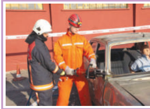
Kapı Açma ve Tavanı Gövdeye Bağlayan Tüm Direklerin Kesilmesinden Sonra Tavan Komple Çıkarılabilir.
